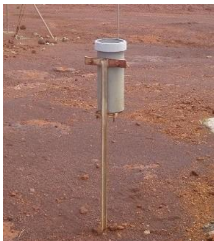
Figure 2 : Dispositif de collecte des eaux de pluie
