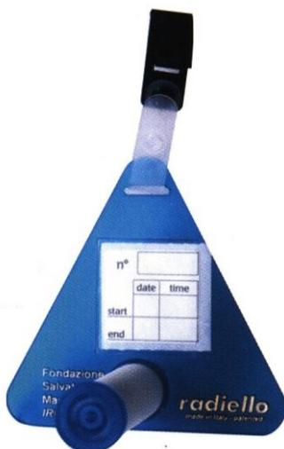
*Figure 4. : Exemple d'implantation d'un tube dans son abri de protection*
