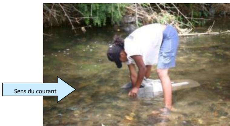
**Photo 3 : Prélèvement de macroinvertébrés à l'aide d'un filet SURBER.**
