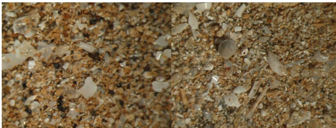
Figure 8 : Observations au microscope optique des fractions  $\varnothing > 40 \mu\text{m}$  des horizons de surface (0-1 cm, photo de gauche) et du bas de la carotte St16 (15-16 cm, photo de droite) dans laquelle la proportion de débris carbonatés issus des micro-organismes marins est supérieure. Grossissement x 11,5.
