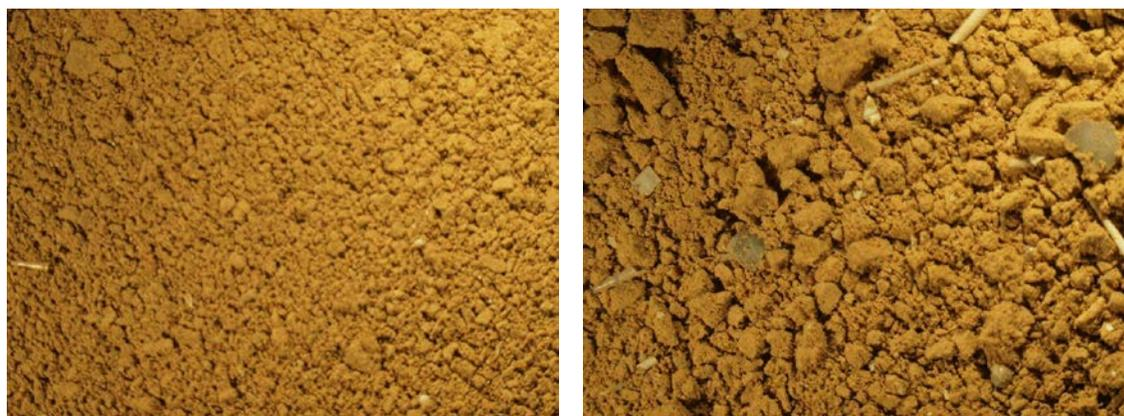
Figure 4 : Observations au microscope optique des horizons de surface (0-1 cm, photo de gauche) et du bas de la carotte (19-20 cm, photo de droite) dans laquelle la proportion de débris carbonatés issus des micro-organismes marins est supérieure. Grossissement x 11,5.
