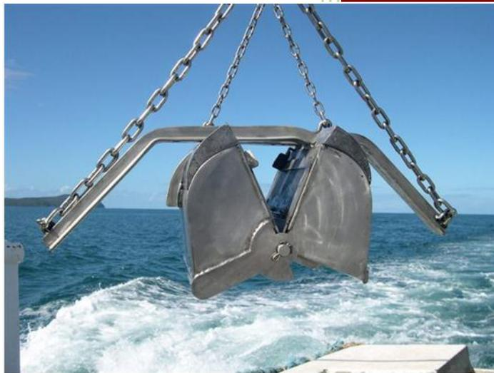
*Photos de couverture AEL : Benne Van-Veen utilisée pour le prélèvement des sédiments de surface.*
